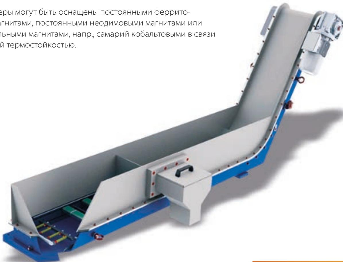
Данный магнитный конвейер используется в основном для зуборезных станков, технологий, в процессе которых возникает мелкая стружка, а также пил для резки металлического (магнитопроводящего) материала.
