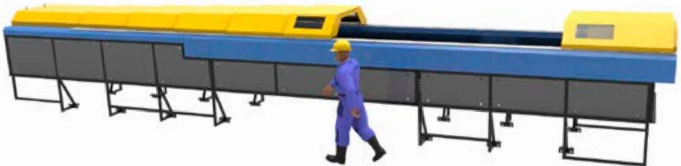
*Капотирование электроэрозионных станков в том числе и телескопическими защитными кожухами.*
